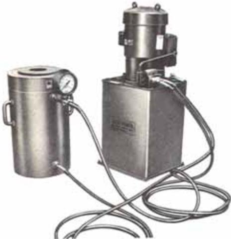
Com barra de tração inserida através do furo passante do pistão, quando este pistão é levantado, na extremidade posterior da barra forma-se um excelente elemento de tração ou compressão, atuando contra a base do macaco, facilitando enormemente os serviços, como sacar polias, extraírem camisas e buchas e também a colocação sob pressão dessas peças ou outras variantes que exijam rapidez de operação e força de tração ou compressão com um máximo de precisão.
